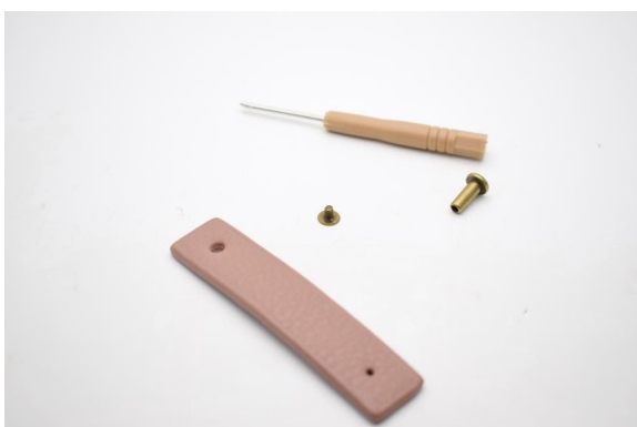
33. Montere PU remmen ved å brette den ned over kanten på kurven. Skru den fast med skruenaglen.
